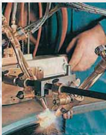
Фото 7 Quisky-E с дополнительным устройством и ведущими роликами для К-образных резов
