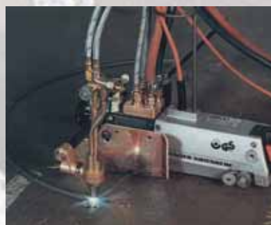
Фото 4 Quicky-E с устройством для круговой резки (диаметр 60– 1500 мм)
