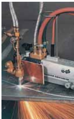
Фото 1 Фигурная ручная резка по разметке
