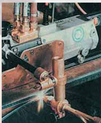
Фото 8 Quisky-E со специальным устройством для заостряющих резов
