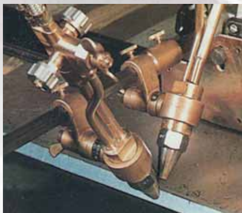
Фото 6 Переносная газорезательная машина Quisky-E с двумя горелками для X-, Y-резов и резки полос
