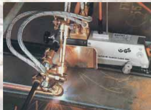
Фото 6 Переносная газорезательная машина Quisky-E с двумя горелками для X-, Y-резов и резки полос
