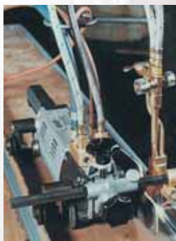
Фото 3 Автоматическая прямолинейная резка с боковыми направляющими роликами на угловых профилях
