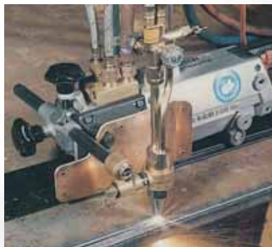
Фото 2 Автоматическая прямолинейная резка с направляющими рейками
