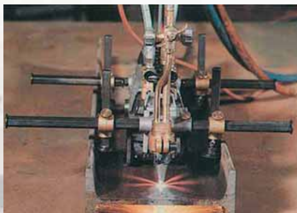
Фото 9 Quisky-E с дополнительным устройством для прямолинейных резов по двутавровым балкам
